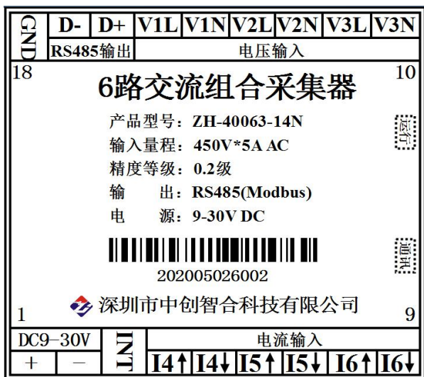
图 5.1 6 路电压输入引脚定义图
